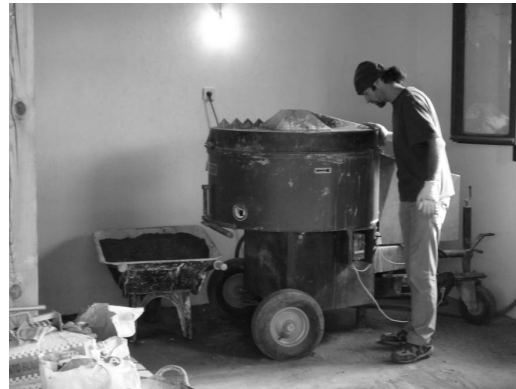
Figura 2. Vista de la fase de mezclado en taller: Mezcladora planetaria
