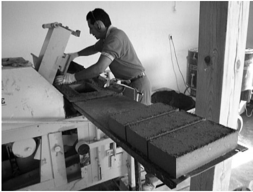
Figura 3. Vista de la fase de prensado: Prensa mecánica semiautomática
